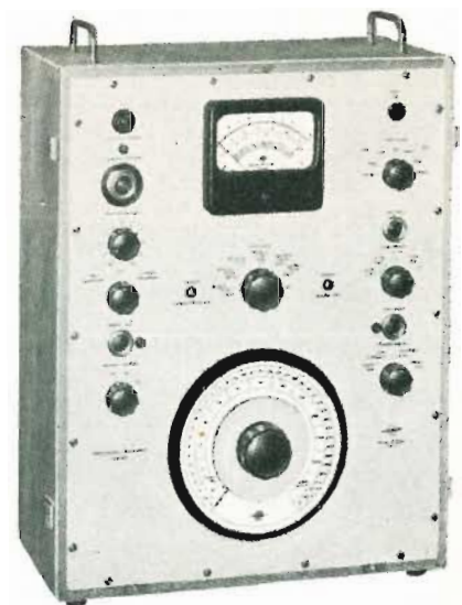
g) Spettrometro Tipo 2111 per l'analisi di disturbi e vibrazioni a banda 1/3 di ottava e a banda di un'ottava.
